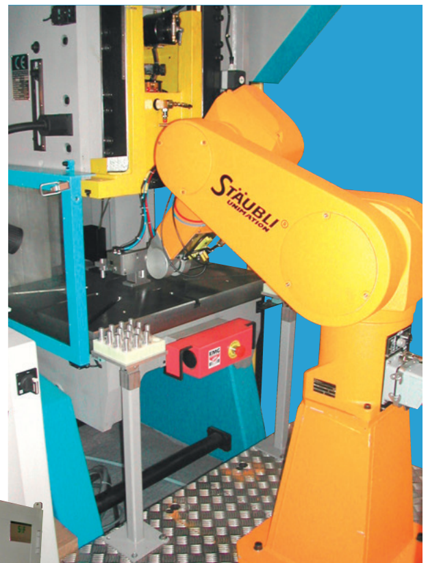
Presse 25 T avec chargement automatique robotisé
